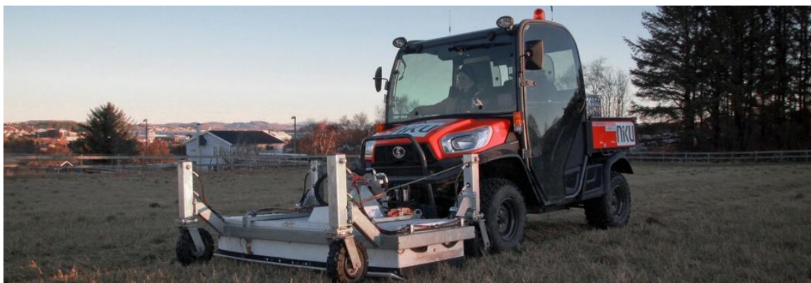
Figur 8.1 Georadar montert på terrengkjøretøy
