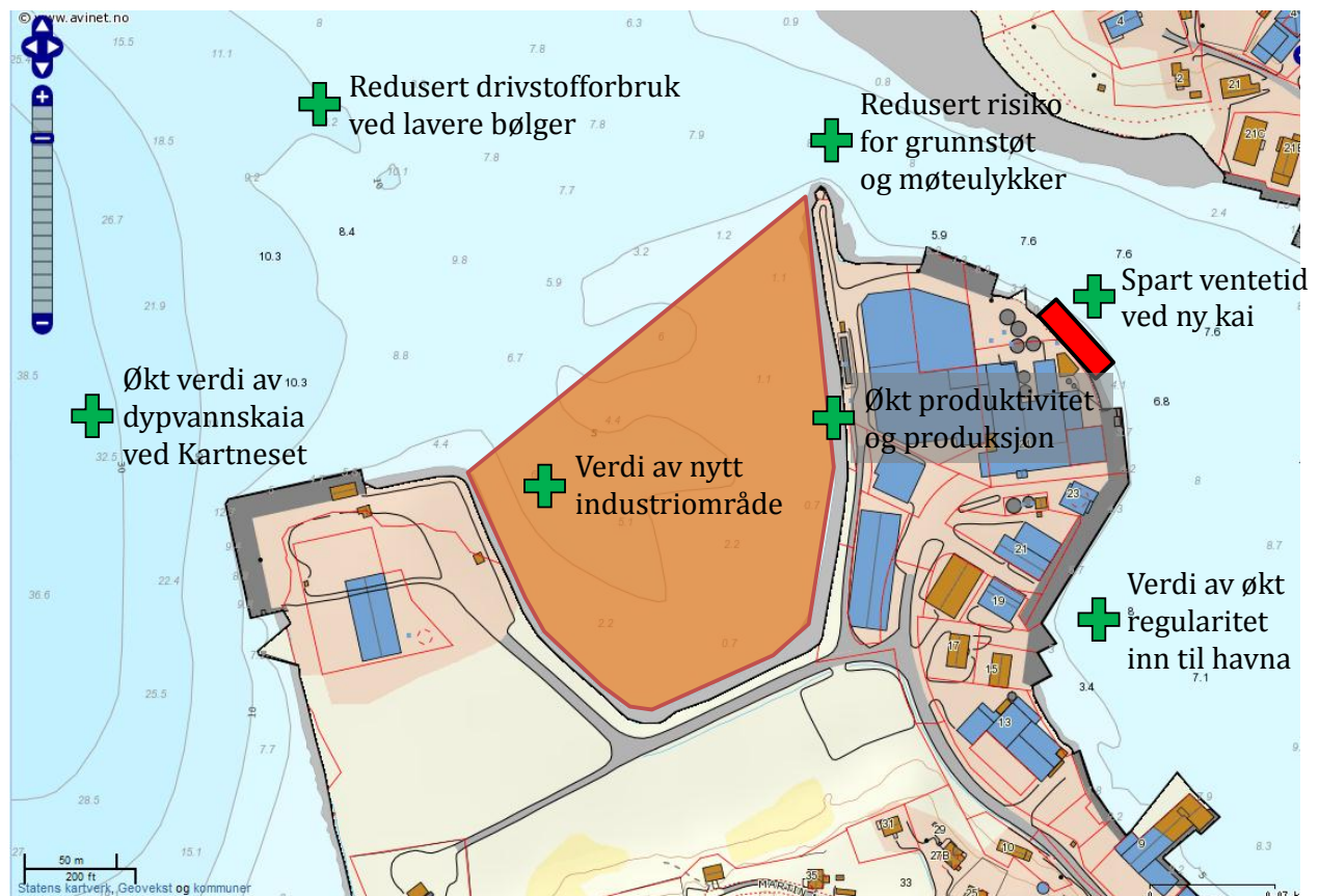
Figur 5.1 Illustrasjon av nytteeffekter ved bygging av molo og utdyping i tilknytning ved Myre fiskerihavn
